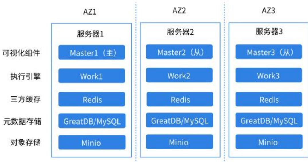
**Master:** 高可靠的可视化配置管理控制台，负责任务的配置、管理和调度。一般采用多节点多实例部署，多节点互备，只会有一个被选为主节点，轻负载。
